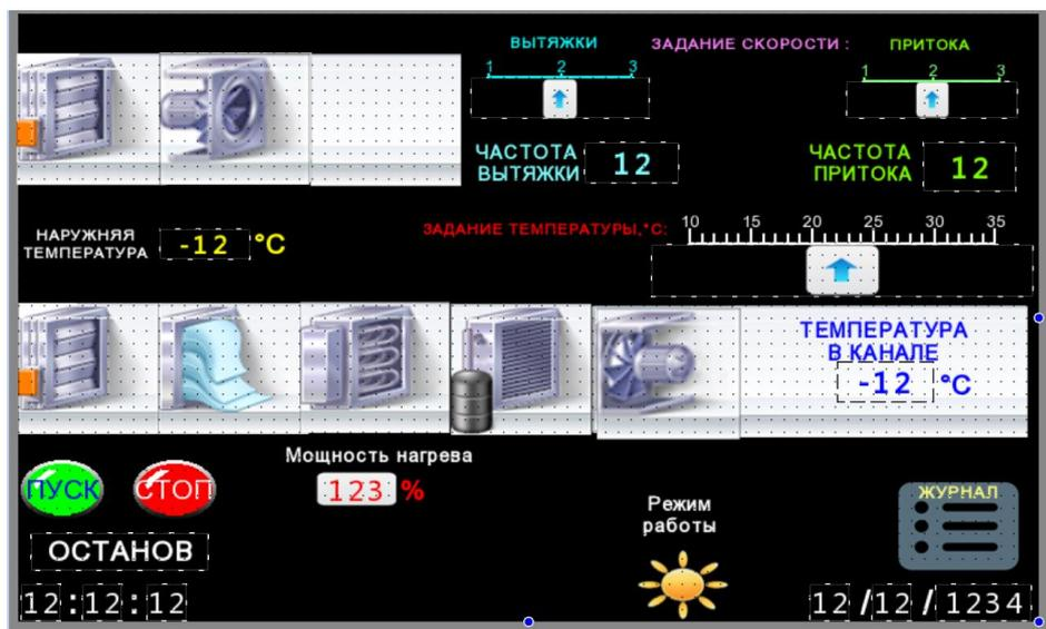
Рисунок 3.16 – Интерфейс НМІ панели.
